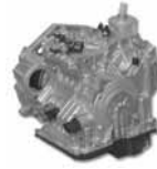
09G: 6-Gang- Automatik- getriebe
